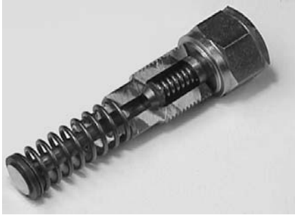
Vakiotuottoisen pumppuelementin poikkileikkaus, ilman ylipaineventtiiliä.
